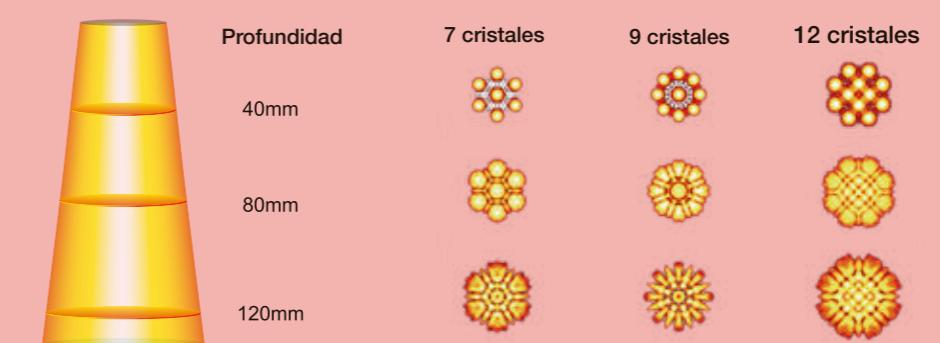
La sonda de ultrasonidos con 12 cristales emplea una avanzada tecnología única de EDAN, proporcionando un haz más amplio y una señal más homogénea, logrando un mejor rendimiento de los monitores que con transductores convencionales.
