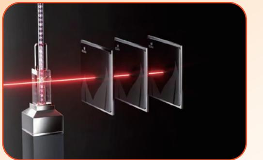
Los analizadores de hematología de la serie H80 utilizan la tecnología láser semiconductor para la diferenciación de WBC. La dispersión en 3 ángulos diferentes refleja la información de las células de forma integral.
